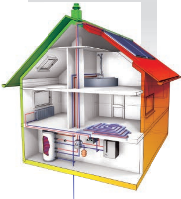
Sanierungsvariante Gas-/Öl-Brennwerttechnik mit Solarthermie
