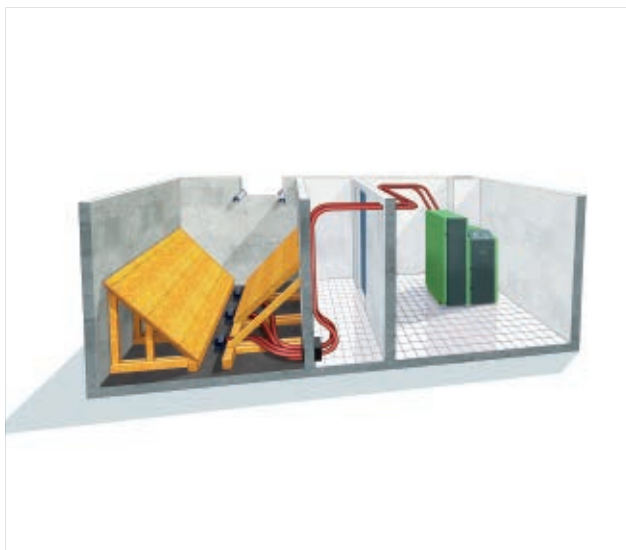
Abb. 54: Mit Pellets betriebene Holz-Zentralheizung mit Austragungssystem
