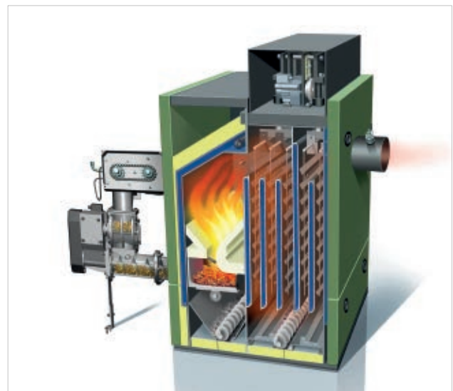
Abb. 55: Schnittdarstellung einer Hackschnitzelheizung
